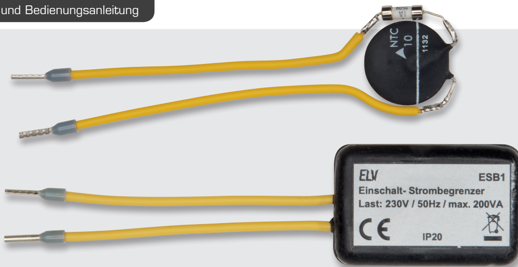
Bild 4: Die Schaltung vor und nach dem Vergießen
